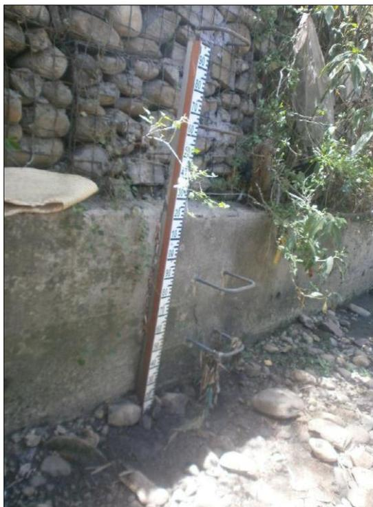
**Figura 2.** Estación limnimétrica
